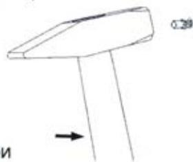
В дюбель вкрутить подвесные крючки при помощи отвертки с прямым шлицем, оставив расстояние между стеной и головкой крючка 0.5 - 1 см.
